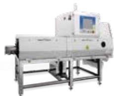
适用于干香菇、豆荚、干辣椒、蒜片、胡萝卜片、西兰花等各类散料，聚合X光、可见光、红外多光谱及AI智能算法，可识别原料内部问题（例如：豆荚虫洞、缺粒）及外观问题。
