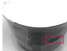
热缩膜桶面侧面破损
