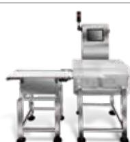
适用于中小包装类预制菜在线重量检测。多种快速剔除机构可供选择，满足不同产线需求。
