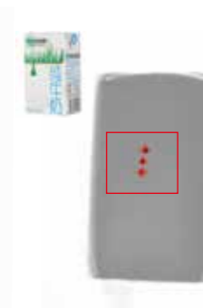
铝箔盒装牛奶 x光机检测异物成像
