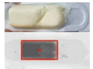
x光机检测奶酪棒棒体缺失
