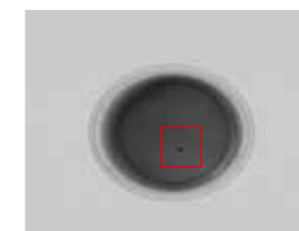
盒装酸奶顶部 x光机检测异物成像
