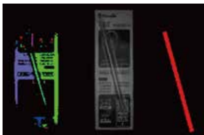
视觉检测机可剔除吸管漏装产品
