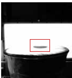
热缩膜桶面顶部破损成像
