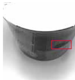
热缩膜桶面侧面破损
