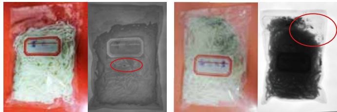
袋装外观霉点、漏气不合格品图像
